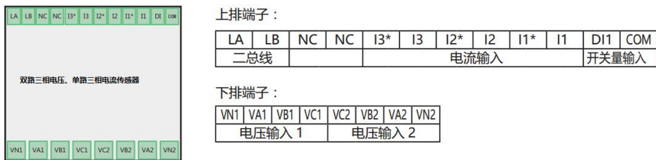
图 2.10 双路三相电压电压，单路三相电流传感器端子图
